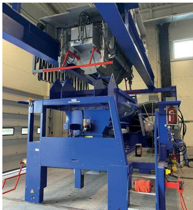
Rozścielacz mieszanki betonowej.
